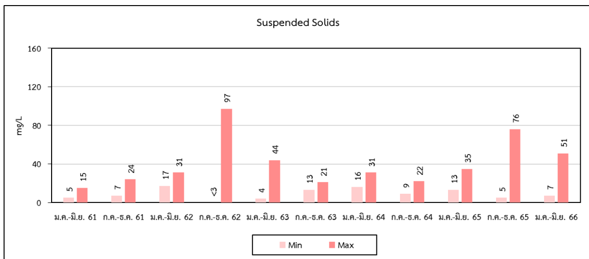
รูปที่ 3-13 กราฟเปรียบเทียบผลการตรวจวิเคราะห์คุณภาพน้ำทิ้งจากกระบวนการผลิต ระหว่างปี พ.ศ. 2561-2566
